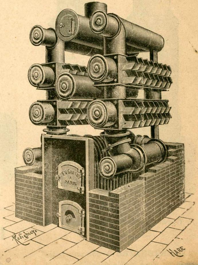
Appareil conforme aux conclusions de l'Académie de Médecine. — Tirage direct. Réglage par le cendrier. Suppression de la clef. Se charge et s'allume par la porte ou brûle le coke et l'anthracite. Il marche jour et nuit sans s'éteindre. Il est muni d'un saturateur.
